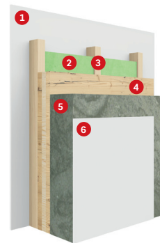
Wandaufbau Holzständerbauweise mit WDVS
