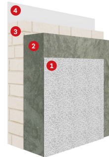
Wandaufbau Kalksandstein mit WDVS
