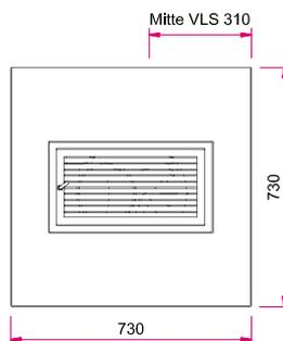
**Hinweis Seitenansicht links M 1:25:** AS: Abgasstutzen, VLS: Verbrennungsluftstutzen, OKFF: Oberkante Fertigfußboden
