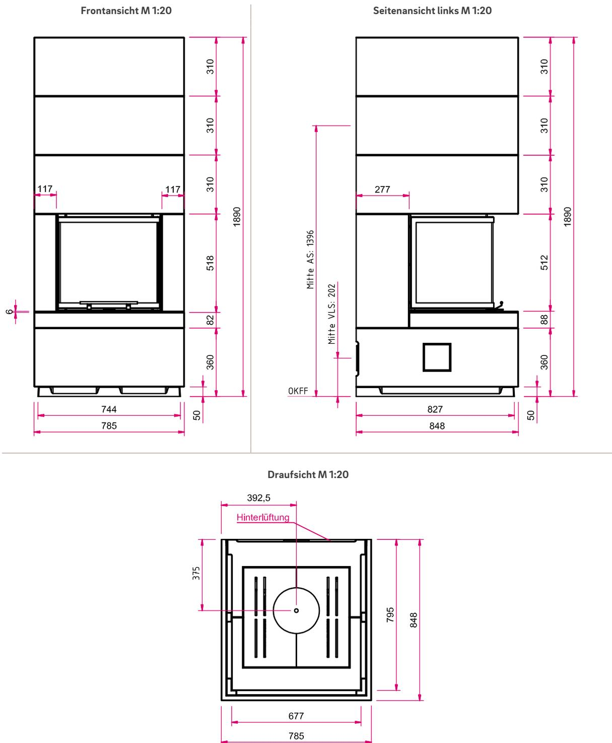
**Hinweis Seitenansicht links M 1:20:** AS: Abgasstutzen, VLS: Verbrennungsluftstutzen, OKFF: Oberkante Fertigfußboden
