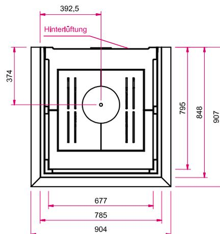
**Hinweis Seitenansicht links M 1:20:** AS: Abgasstutzen, VLS: Verbrennungsluftstutzen, OKFF: Oberkante Fertigfußboden
