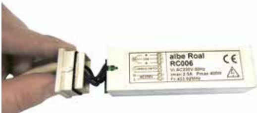
4.1 Seitliche Abdeckung mit der Platine vorsichtig aus dem Gehäuse ziehen.
