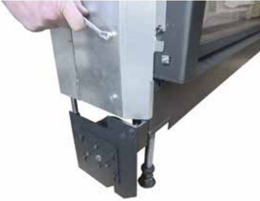
3.14 Abdeckbleche rechts und links wieder montieren
