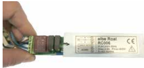
4.4 Die Platine mit den Anschlussleitungen in das Gehäuse schieben und seitliche Abdeckung wieder einschieben.
