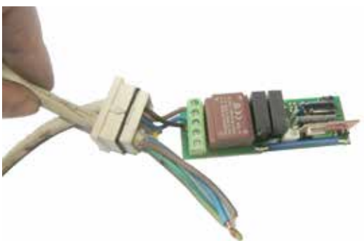
4.2 Zuleitung 230V (nicht im Lieferumfang enthalten) durch die zweite Öffnung in der Abdeckung stecken...
