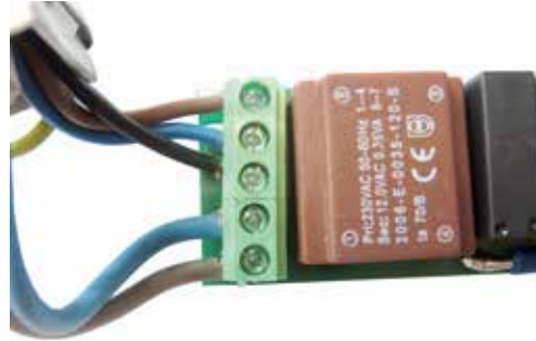
4.3 ... und Anschlussleitungen wie abgebildet anschließen. Bitte diese Arbeiten nur von einem Elektrofachmann ausführen lassen.
