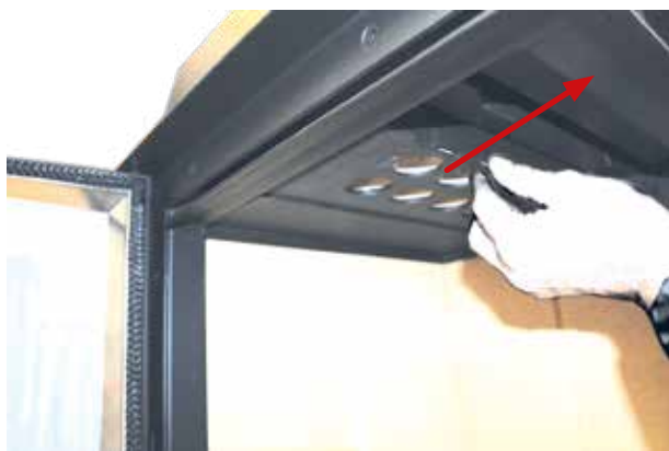
Abb.:20 SCC nach vorn ziehen
