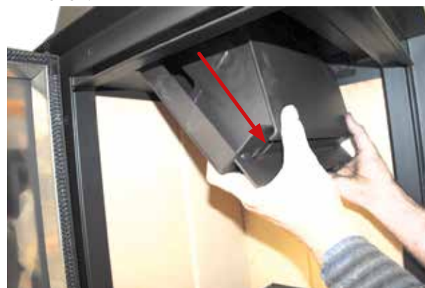
Abb.:15 SCC entnehmen
