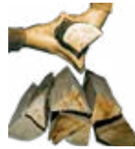
Scheitholz: (naturbelassen, luftgetrocknet, Feuchtegehalt max. 15%, Abb. mit Faustregel für max. ø)
