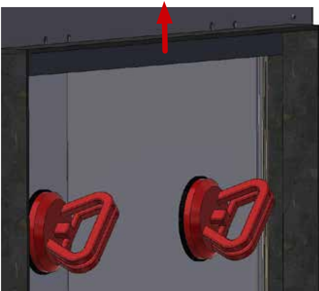
Abb.:1 Ausbau der Scheibe LINA G 87
