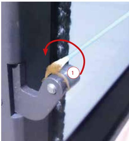
1. Ouvrez la porte et appliquez un peu de pâte de lubrification sur le coton-tige. Appliquez-la entre le rouleau de verrouillage (1) et la bobine. Tournez le rouleau de verrouillage.
