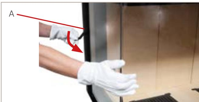
Fig. 38 : Fermer le levier de verrouillage
