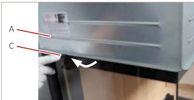
Fig. 32 : Languette de fermeture latérale ouverte
